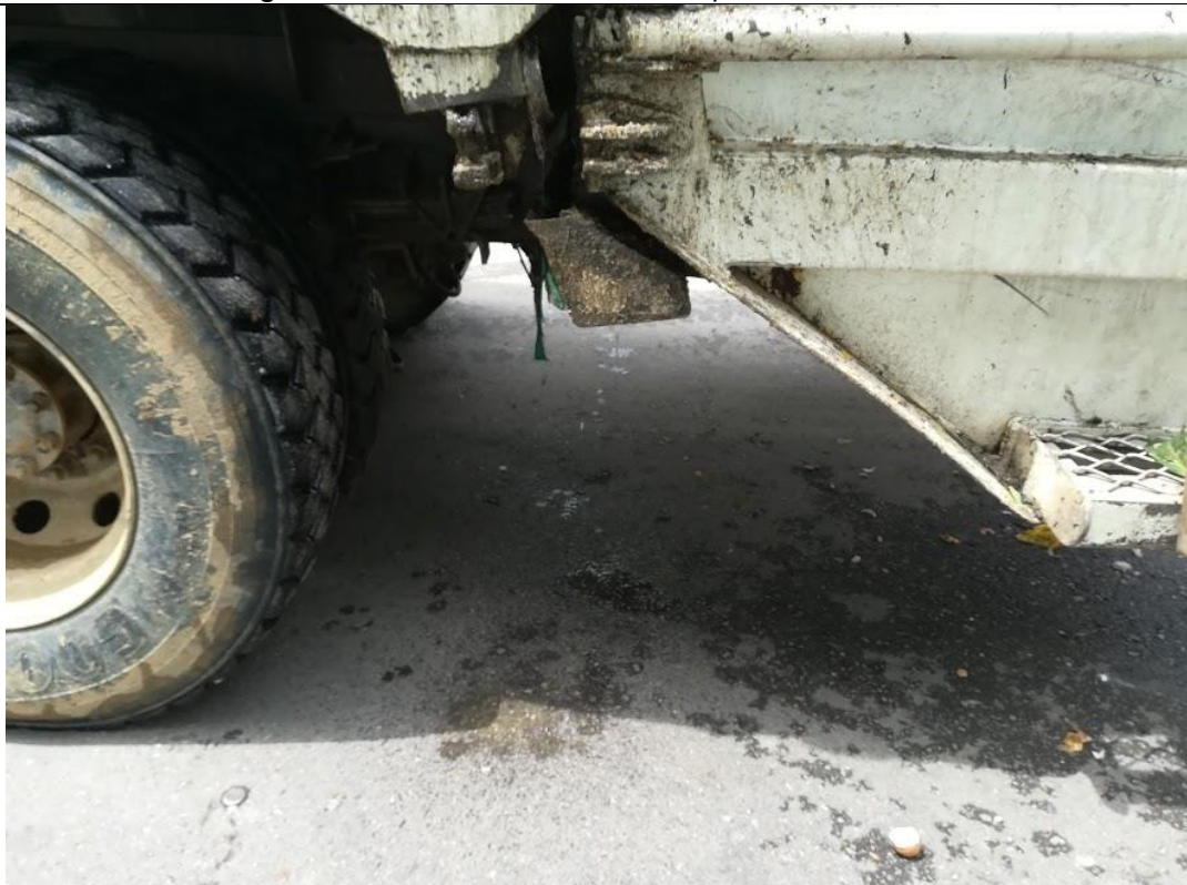
Fotografía 13. Caja de Lixiviados con Fuga
