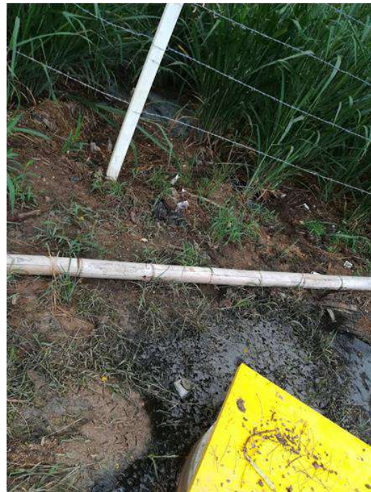
Fotografía 15. Vertimiento desde la laguna 2 hacia el terreno aledaño
