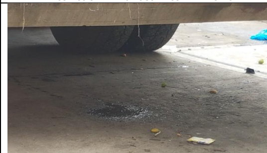
FUGA DE LIXIVIADO DEL VEHICULO COMPACTADOR
